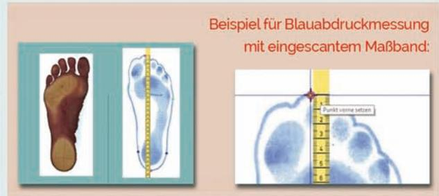
Beispiel für Blauabdruckmessung mit eingescantem Maßband:
